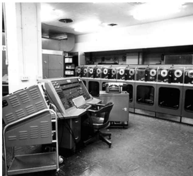
รูปที่ 8.4 เครื่องยูนิแวกขนาดใหญ่เต็มห้องแต่มีหน่วยความจำน้อย
