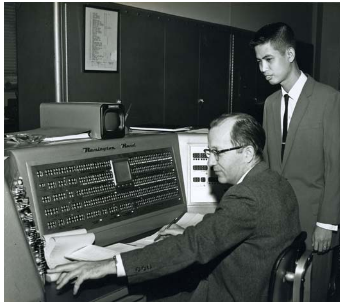
รูปที่ 8.5 อาจารย์กำลังสอนให้ผมนำโปรแกรมภาษาเครื่อง ซึ่งเป็น 0 กับ 1 เข้าเครื่องโดยการสับสวิตช์ขึ้นลง
